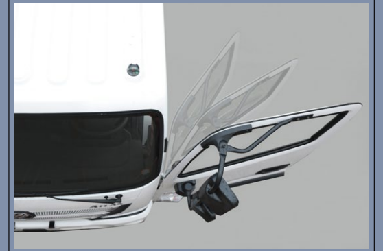
Kademeli olarak 90° açılabilen güçlendirilmiş yan kapılar
