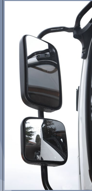
Isıtmalı ve elektrik kumandalı dış aynalar
